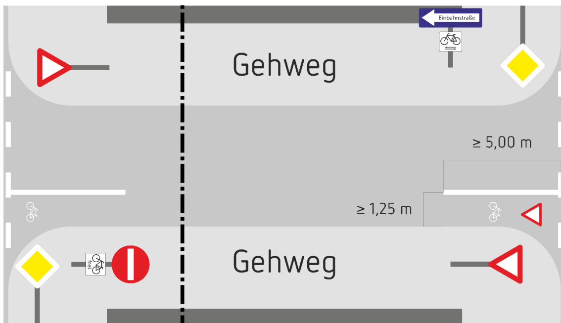
Abbildung 22: Einbahnstraße mit Radverkehr in Gegenrichtung (Beispiel für vorfahrtgeregelte Einmündungen mit Fahrradporten für den Radverkehr in Gegenrichtung)
